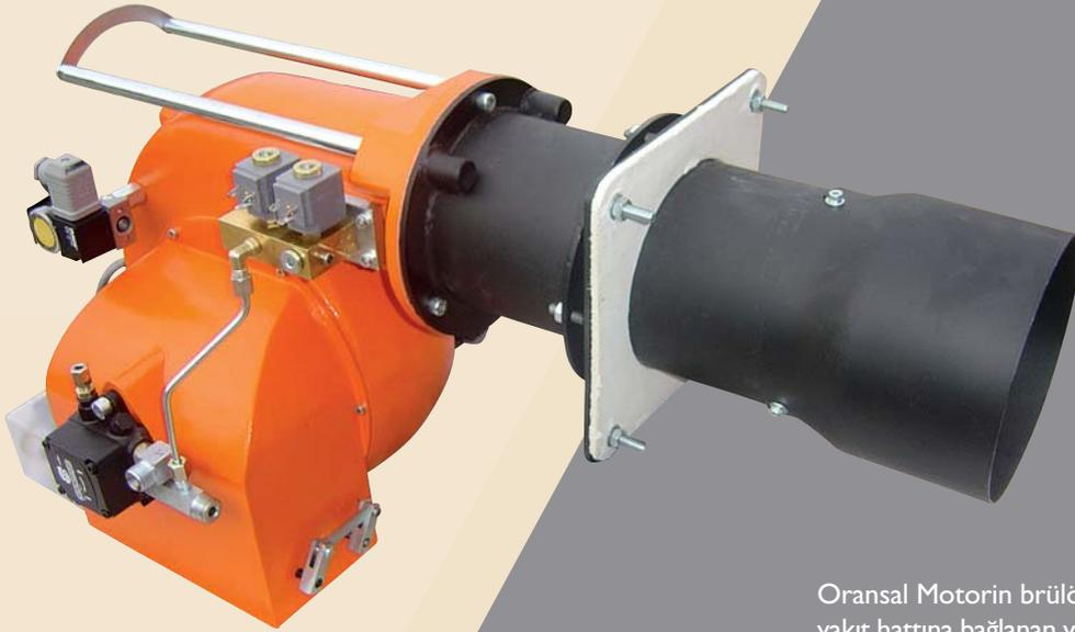
Oransal Motorin brülörlerinde lansenin geri dönüş yakıt hattına bağlanan ve geri dönüş yakıt basıncını değiştirme imkanı sağlayan yağ ayar ventili kullanılmaktadır. Lansenin geri dönüş yakıt basıncını değiştirmek suretiyle lansenin memesinden çıkan yakıtın miktarı, basıncı ve pulverizasyonu değişir. Daha iyi bir pulverizasyonla max yanma verimi elde edilir.
