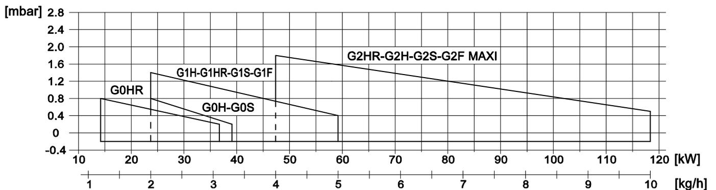
Fig. 2 X = Caudal Y = Presión en la cámara de combustión
